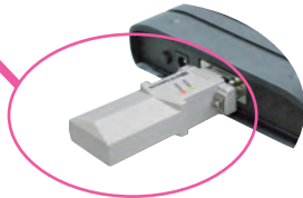
シリアルデバイスの D-Sub9Pinコネクタに装着
