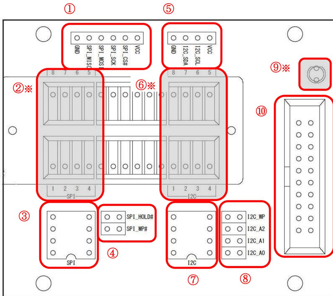
※「② 28pin ソケット (SPI)」「⑥ 28pin ソケット (I2C)」「⑨ LED」は未実装となりますので、必要に応じて実装してください。
